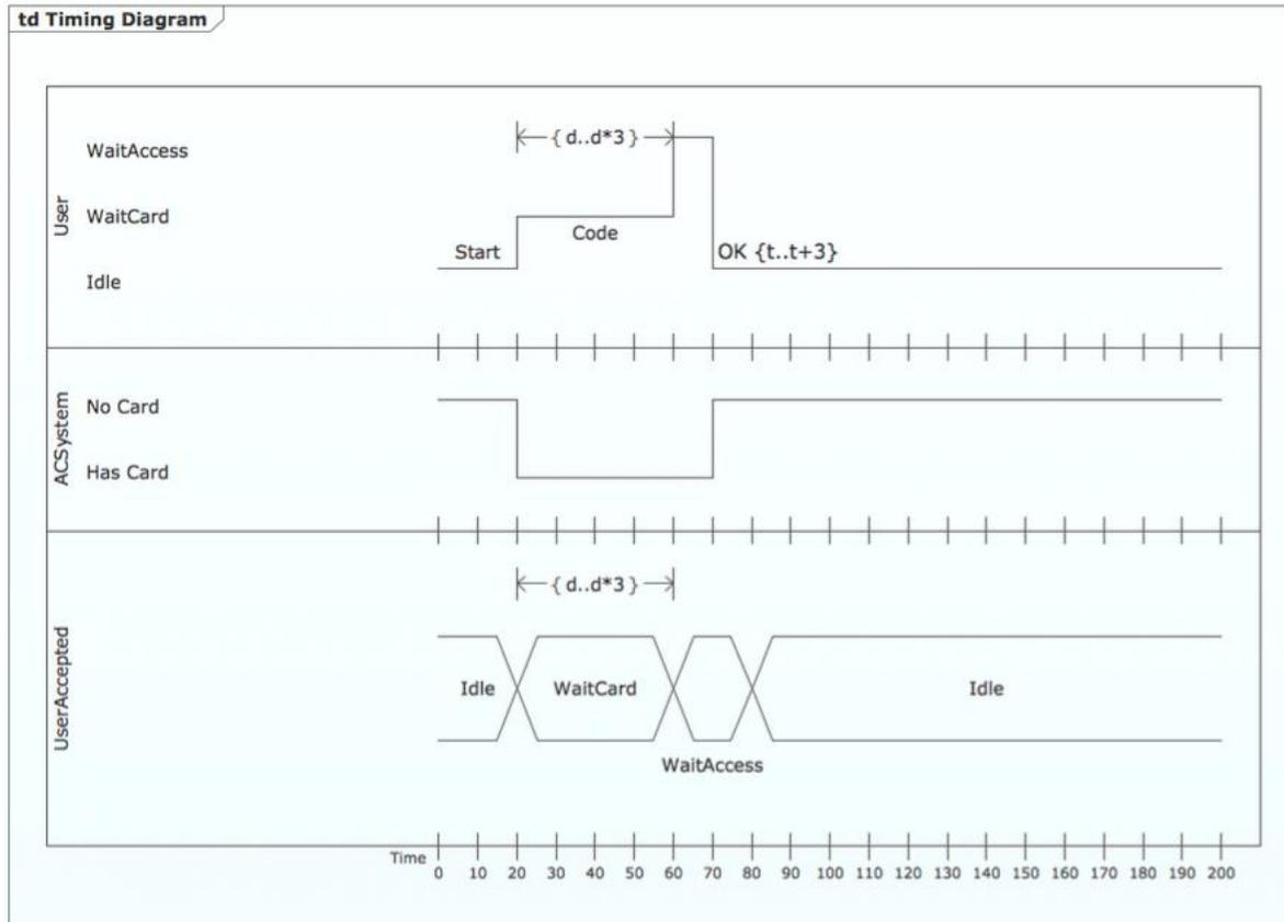
타이밍 다이어그램(timing diagram)은 또 다른 종류의 교류 다이어그램이다. 세부 타이밍 정보와, 교류하는 요소들의 상태 또는 조건 정보에 대한 변경 사항을 나타낸다.
