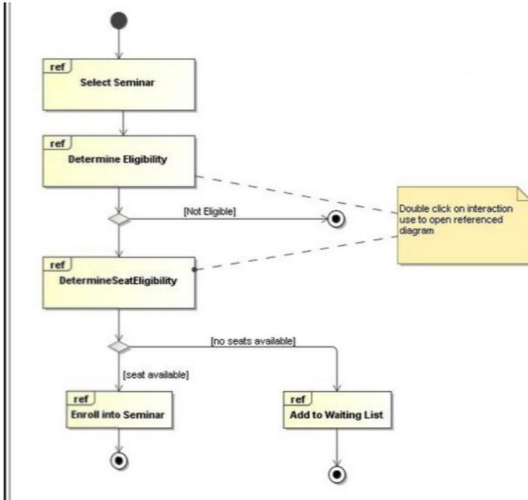
교류 개요 다이어그램(interaction overview diagram)은 교류 순차들(interaction sequences) 사이의 제어 흐름에 대한 개요를 보여주는 데 사용되는 고수준의 다이어그램이다.
