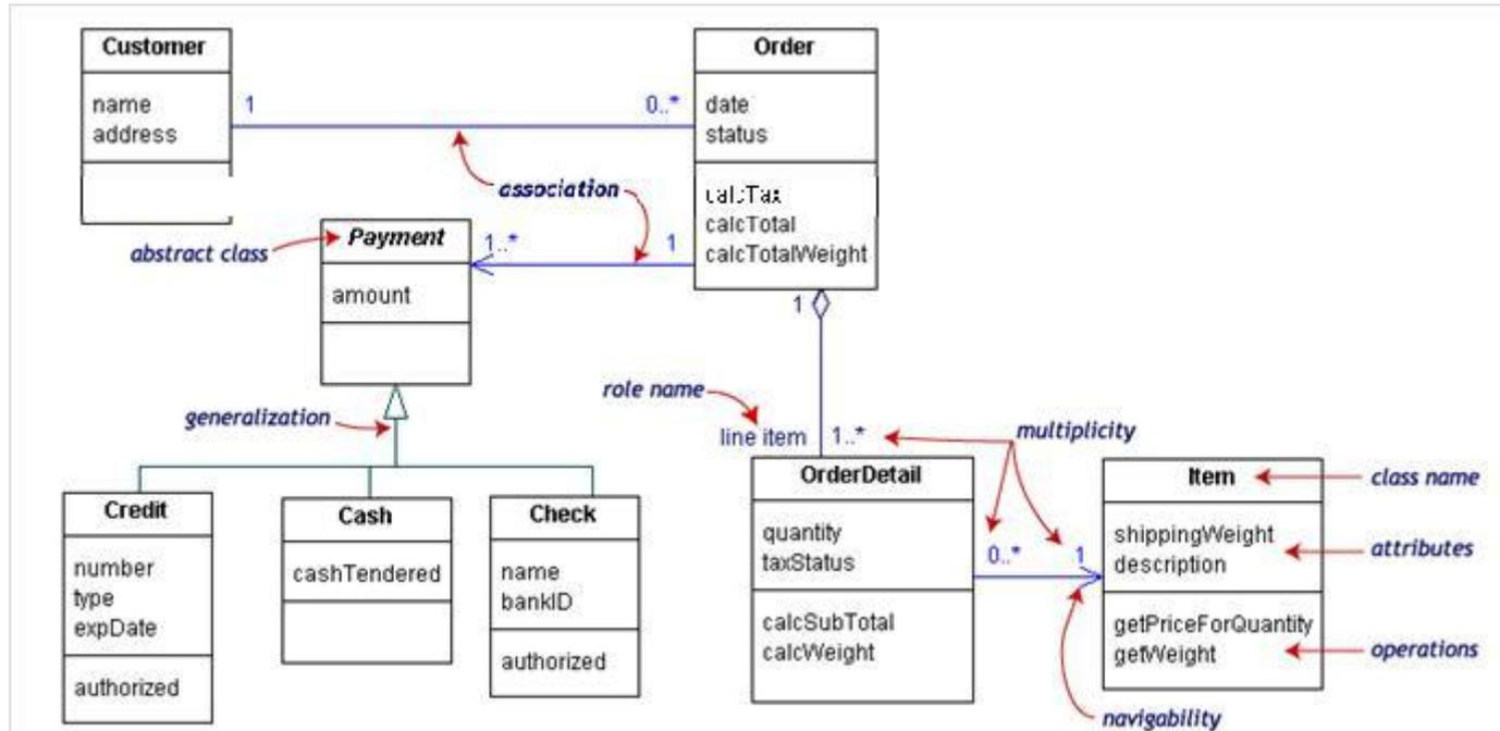
클래스 다이어그램은 UML 모델링에서 사용되는 가장 일반적인 다이어그램으로 시스템, 그 구조 그리고 그들의 상호 관계 내에 존재하는 정적인 것을 나타낸다. 시스템의 논리적 및 물리적 설계를 나타내는 데 주로 사용된다.
