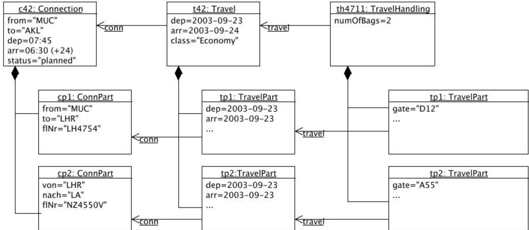
개체 다이어그램은 시스템 내의 일련의 개체들 사이의 관계를 보여주는데, 특정시점에 시스템의 스냅샷을 보여준다.
