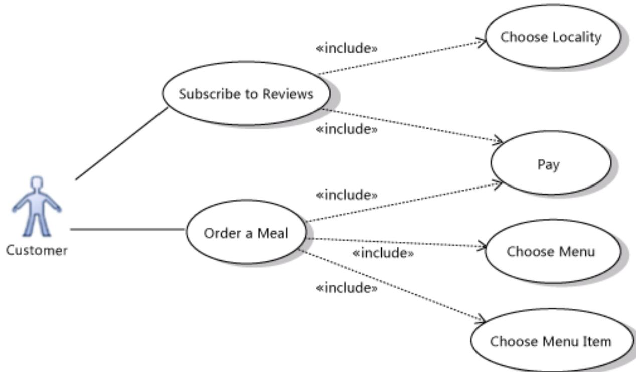
유스 케이스 다이어그램은 시스템이 구현할 업무프로세스를 다룬다. 유스 케이스는 시스템이 작동하는 방법과 시스템과 교류하는 사람들을 나타낸다.
