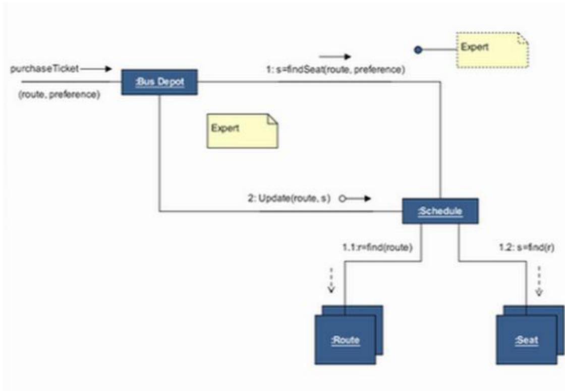
협력 다이어그램(collaboration diagram)은 순차 다이어그램(sequence diagram)처럼 교류 다이어그램(interaction diagram)의 일종이다. 협력 다이어그램은 개체들이 어떻게 협력하고 교류하는지를 강조한다. UML 2.0 에서 협력 다이어그램과 대등한 것은 통신 다이어그램(communication diagram)이다.
