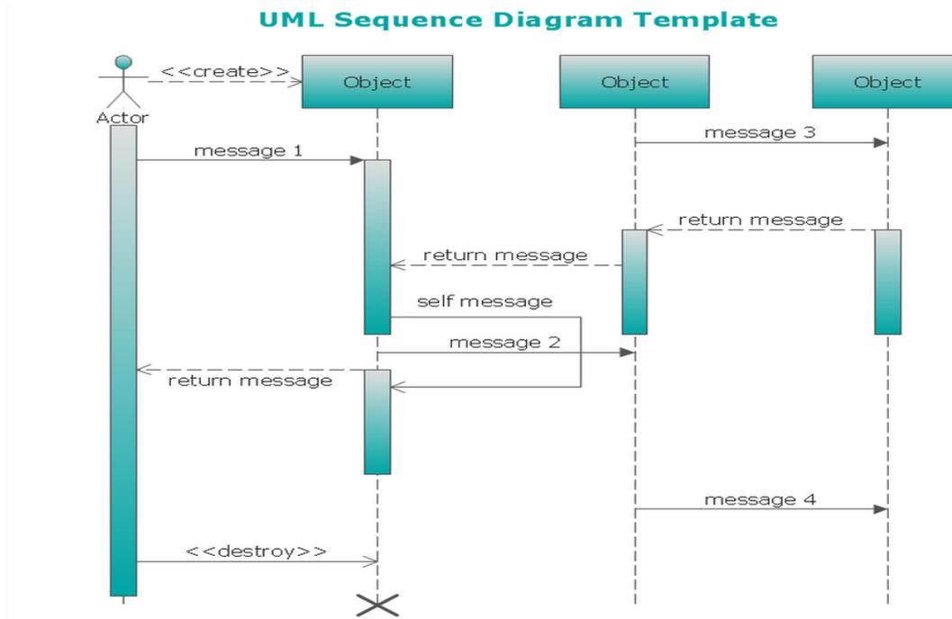
순차 다이어그램(sequence diagram)은 또 다른 종류의 교류 다이어그램이다. 순차 다이어그램은 시스템의 다른 요소들 사이의 메시지들의 시간 순서를 강조한다.
