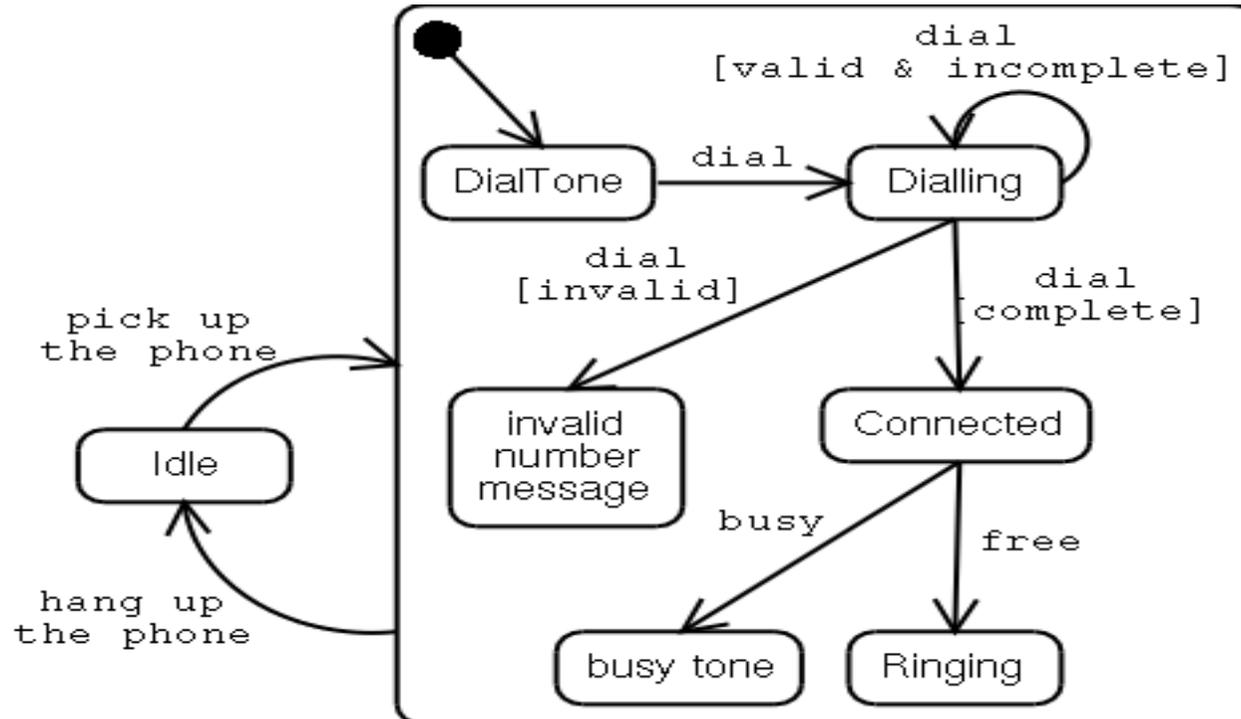
상태 다이어그램은 개체의 상태와, 이 개체가 상태들 사이를 어떻게 전이하는지 보여준다. 상태 다이어그램은 상태, 전이, 이벤트, 그리고 활동을 포함할 수 있다. 상태 다이어그램은 동적 뷰를 제공하며, 이벤트 중심의 행동을 모델링할 때 매우 중요하다. 예를 들어, 전화 교환 시스템 내의 스위치를 나타내기 위해 상태 다이어그램을 사용할 수 있다. 이 스위치는 여러 이벤트들에 기초하여 상태를 바꾸며, 어떻게 이 스위치가 작동하는지를 이해하기 위해 상태 다이어그램에서 이 이벤트들을 모델링할 수 있다. UML 2.0에서는 상태 기계 다이어그램(state machine diagram)이라고 한다.
